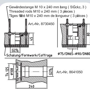
Einbausatz aus Rotguss für alle Schwall-
